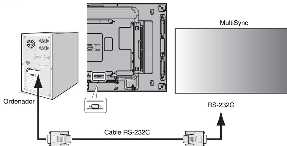
**NOTA:** Si su ordenador sólo tiene un conector de puerto serie de 25 clavijas, es necesario un adaptador de puerto serie de 25 clavijas. Póngase en contacto con su distribuidor si desea más información. Para la asignación de clavijas, consulte la página 53 "2) Entrada/salida RS-232C".
