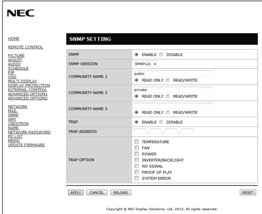
Esta función permite conocer el estado del monitor y controlarlo a través de la red.
