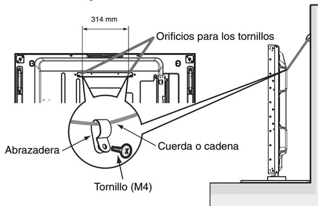
Antes de fijar el monitor LCD a la pared, asegúrese de que ésta puede soportar el peso del monitor.
