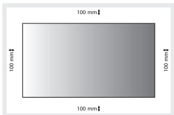
Permita que haya una ventilación adecuada o aire acondicionado alrededor del monitor, de tal forma que el calor se pueda disipar adecuadamente de la unidad y de los aparatos adicionales, sobre todo si utiliza monitores en varias pantallas.
