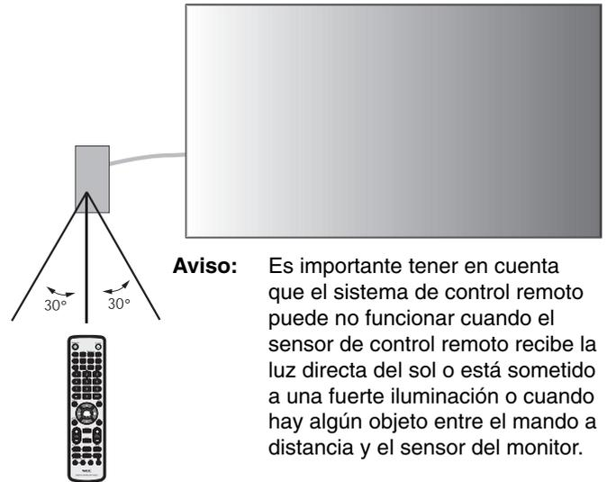
**Aviso:** Es importante tener en cuenta que el sistema de control remoto puede no funcionar cuando el sensor de control remoto recibe la luz directa del sol o está sometido a una fuerte iluminación o cuando hay algún objeto entre el mando a distancia y el sensor del monitor.
