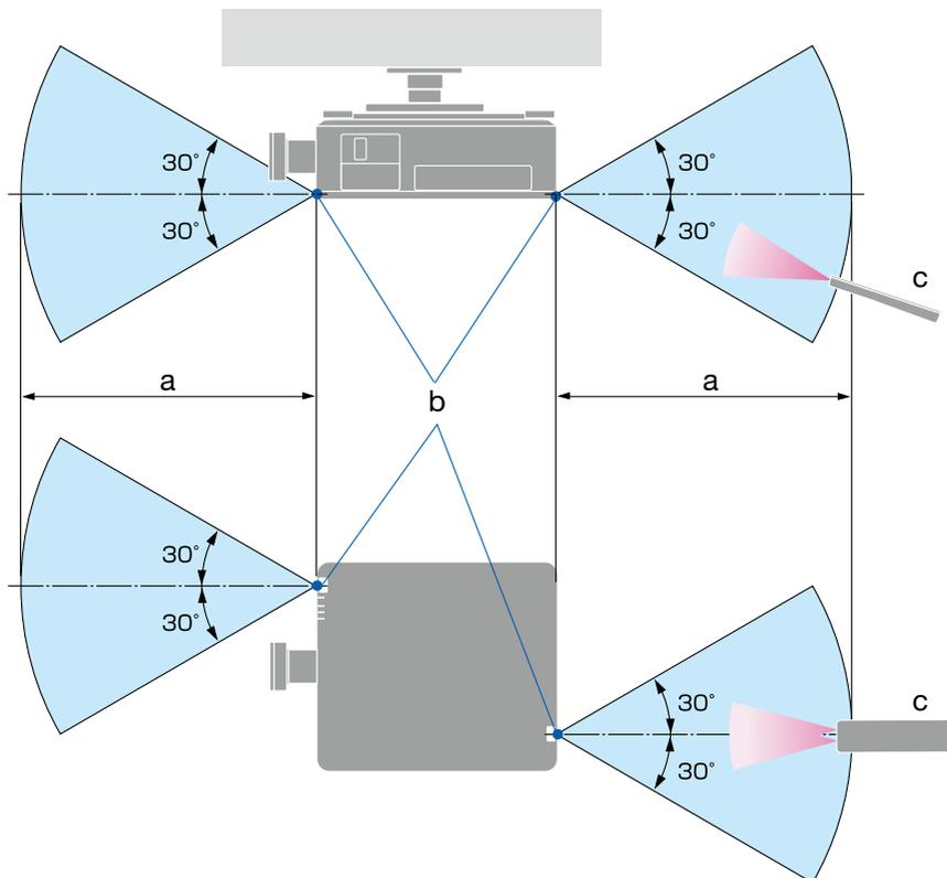
a: 7 m/276" / b: sensor remoto en la carcasa del proyector / c: control remoto
