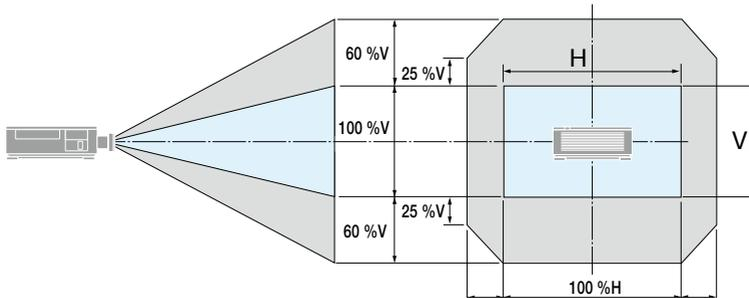
Descripción de los símbolos: V indica vertical (altura de la imagen proyectada), H indica horizontal (anchura de la imagen proyectada).
