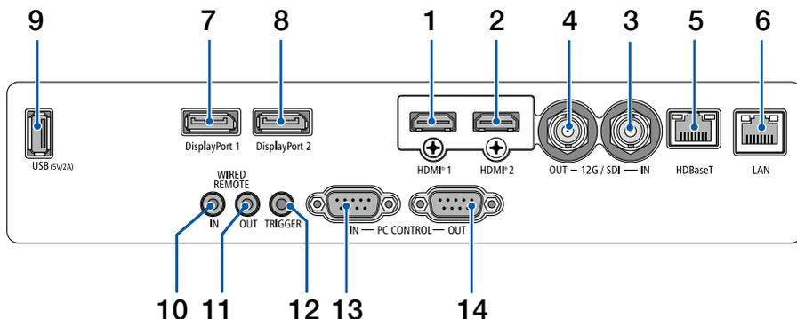
**11. Terminal SALIDA DEL CONTROL REMOTO POR CABLE**
