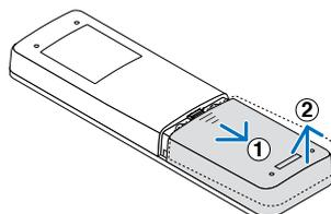
2. Installez des piles neuves (piles alcalines ou au manganèse AAA). Veillez à ce que la polarité (+/-) des piles soit correctement alignée.
