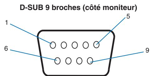
Ce moniteur utilise des lignes RXD, TXD et GND pour le contrôle RS-232C.
