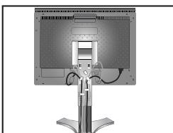
Asegúrese de no tensar los cables para que las funciones Inclinar, Subir y Bajar del monitor funcionen correctamente.
