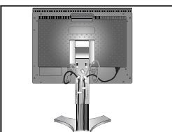
Assurez vous de laisser assez de distance dans les câbles pour que l'inclinaison et les fonctions de relèvement et de descente du moniteur ne soient pas entravées.
