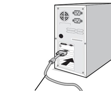
Cable de señal mini D-SUB de 15 clavijas
