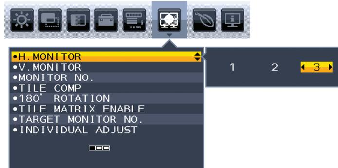
4. Pulse la tecla ABAJO/ARRIBA para seleccionar PANTALLAS V. Pulse la tecla IZQ./DCHA. para establecer PANTALLAS V 3.
