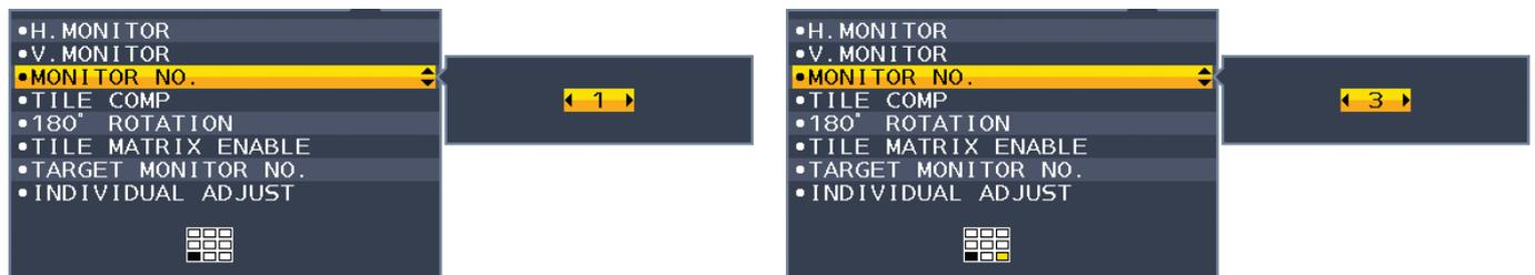
6. Pulse la tecla ABAJO/ARRIBA hasta seleccionar TILE MATRIX ACTIVO y establezca la opción en ENCENDIDO. Configure individualmente todos los monitores conectados siguiendo los pasos del 1 al 6 de arriba.
