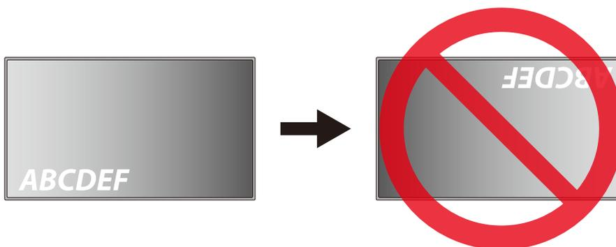
Le moniteur ne peut pas être utilisé avec une inclinaison de 10° ou plus.
