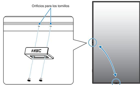
**AVISO:** No use ningún otro tornillo para colocar el adorno del monitor.
