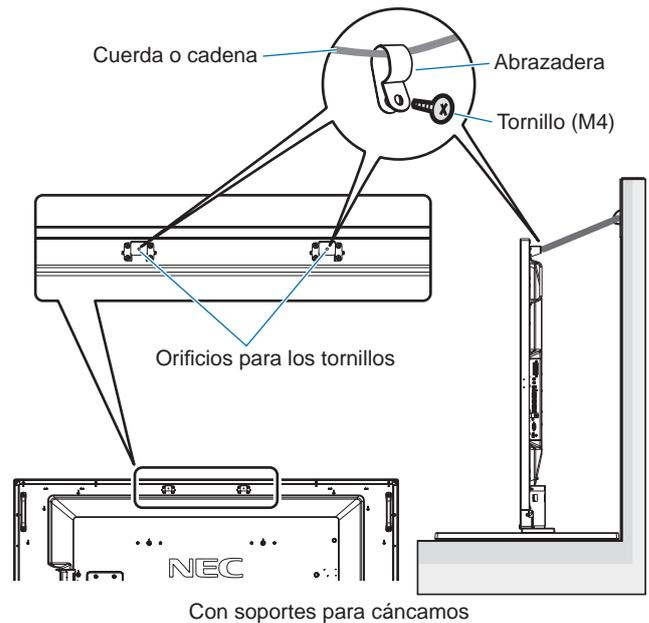
Antes de fijar el monitor LCD a la pared, asegúrese de que ésta puede soportar el peso del monitor.
