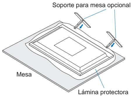
**NOTA:** Instale el soporte según la dirección que indica la flecha que está impresa en la superficie del soporte. Use el ST-801.
