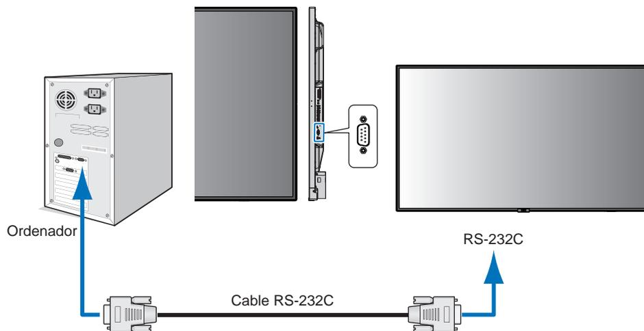
**NOTA:** Si su ordenador sólo tiene un conector de puerto serie de 25 clavijas, es necesario un adaptador de puerto serie de 25 clavijas. Póngase en contacto con su proveedor si desea más información. Para ver la asignación de las clavijas consulte "2) Entrada/salida RS-232C" en la [página 50](#).
