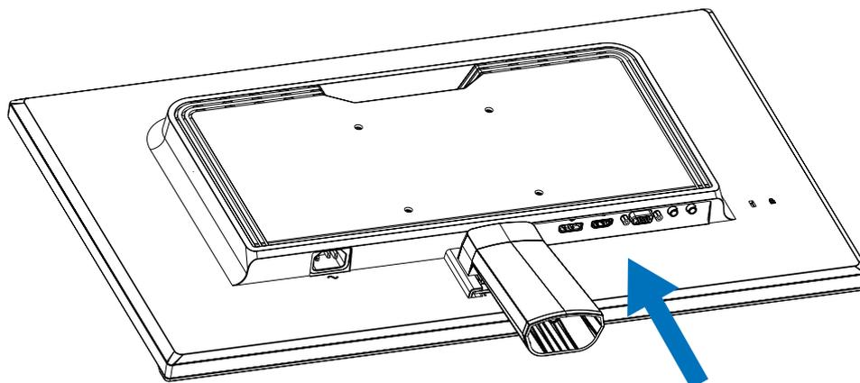
3. Acople el soporte de la base al cuello del soporte. Apriete el tornillo de la parte inferior de la base.
