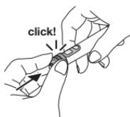
٥- قم بتوصيل قابس كبل USB (الموصل بوحدة المستشعر) بمنفذ USB (من النوع A) (من النوع A) بجهاز الكمبيوتر.
