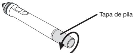
2. Inserte el lado negativo de la pila (AAA) en la tapa de la pila.
