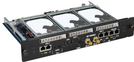
*Um servidor integrado de mídia "tudo-em-um" com armazenamento de 2 TB Raid5 oferecem conectividade versátil e significativas economias, com menos dispositivos periféricos necessários. Uma ampla gama de recursos integrados que inclui um protetor de tela integrado de 2 TB Raid5, duas interfaces HDSDI 3G, funções avançadas de rede e de GPIO embutidas.*
